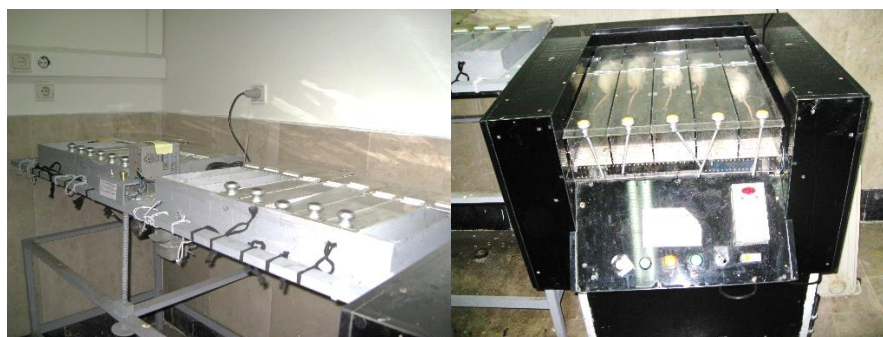
شکل ۱- آزمون دویدن و ورزش اجباری برای اندازه‌گیری پارامترهای بیومکانیکی استخوان تیبیا
